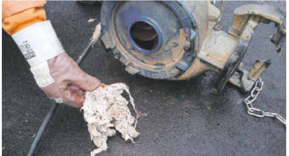
Hygieneartikel und insbesondere Feuchttücher führen zu verstopften Kanälen und Röhren sowie blockierten Pumpwerken, wenn diese Artikel über die Toilette entsorgt werden. Foto: TWF GmbH
