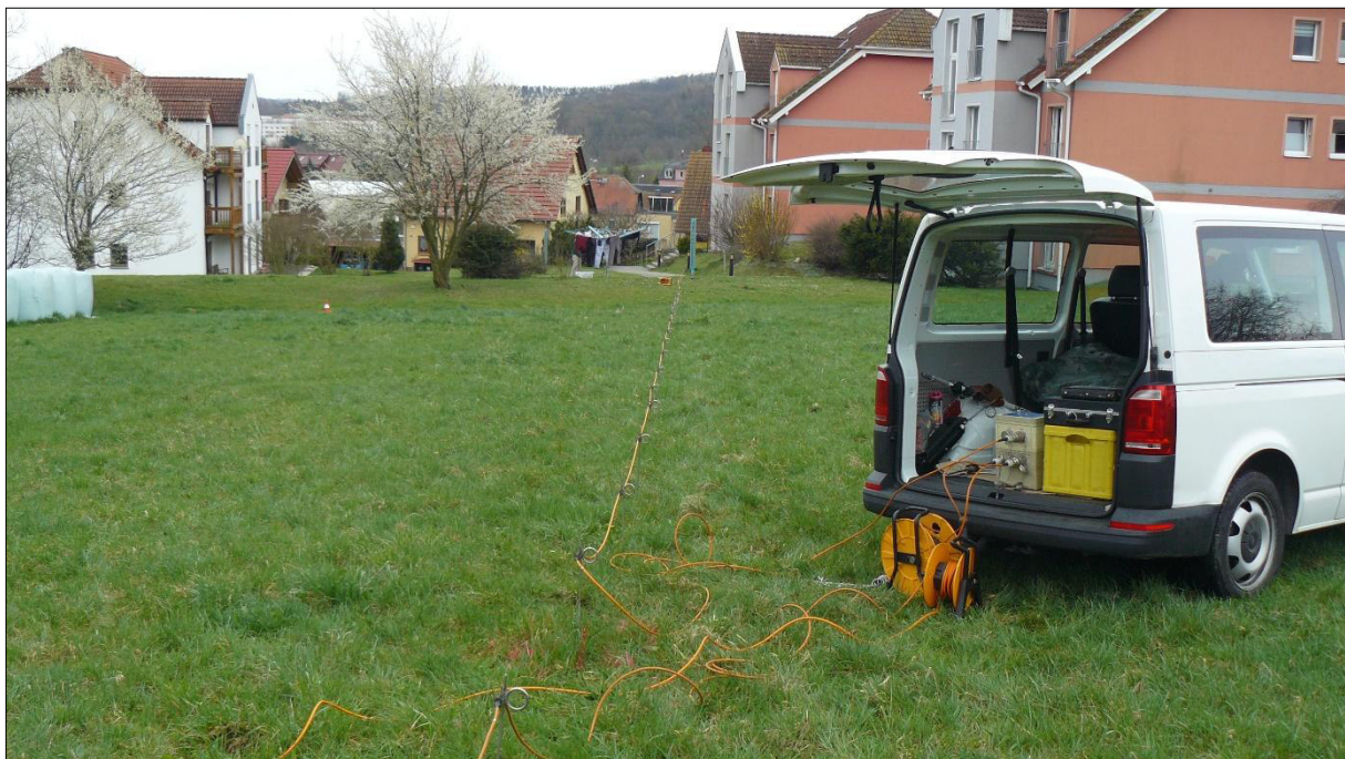
Abb. 2: geoelektrische Messung am Beispiel von Längsprofil LP3
